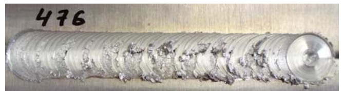
Bild 1: Ohne Strom, 2000 U/min, 2000 mm/min, nicht durchgeschweißt, Werkstoff: AW-5754, Blechdicke: 1,5 mm, Pin-Ø: 3 mm, Schulter-Ø: 8 mm Figure 1: without current, 2000 Rpm, 2000 mm/min, weld imperfection, material: AW-5754, plate thickness: 1,5 mm, pin-Ø: 3 mm, shoulder-Ø: 8 mm
