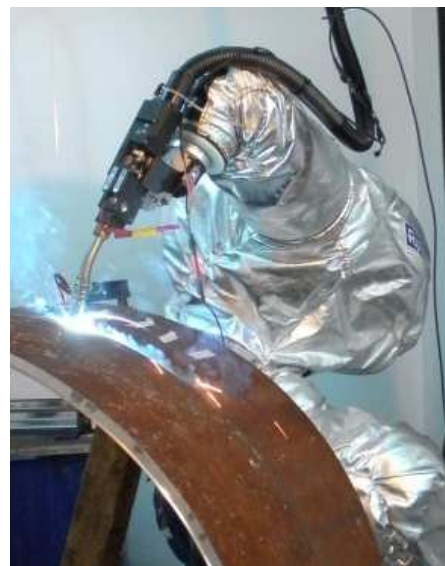
Bild 2: Schweißversuch in Klimakammer Fig. 2: welding experiment in climate chamber
