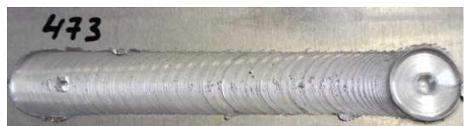
Bild 2: I_{eff} : 4,7 kA, 2000 U/min, 3000 mm/min, durchgeschweißt, Werkstoff: AW-5754, Blechdicke: 1,5 mm, Pin-Ø: 3 mm, Schulter-Ø: 8 mm Figure 2: I_{eff} : 4,7 kA, 2000 Rpm, 3000 mm/min, root fusion, material: AW-5754, plate thickness: 1,5 mm, pin-Ø: 3 mm, shoulder-Ø: 8 mm
