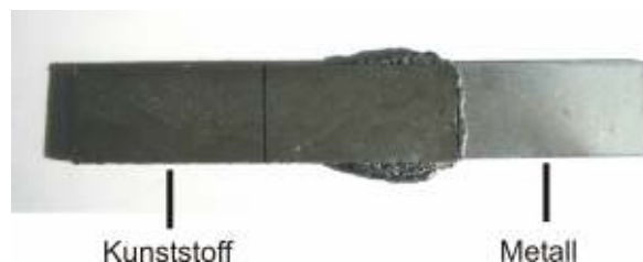
Bild 3: Verbindung durch Induktionsschweißen Fig. 3: Joining with Induction Welding
