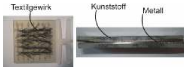
Bild 4: Verbindung mithilfe eines Textilgewirkes Fig. 4: Joining with Interlaced Yarns
