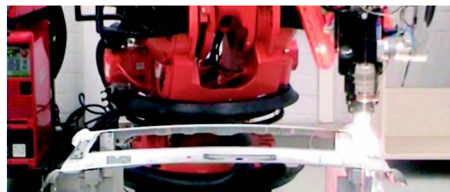
Bild 2: Hybridfügen eines Retractable Hard Top, Quelle: Karmann Fig. 2: Hybrid Joining of a Retractable Hard Top, Source: Karmann
