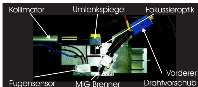
Bild 1: Labor-Hybridschweißkopf mit Sensor zur Prozesssteuerung
