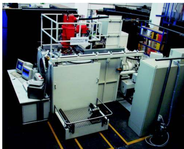
Bild 3: Elektronenstrahl-Schweißanlage des ISF Fig. 3: ISF electron beam welding equipment
