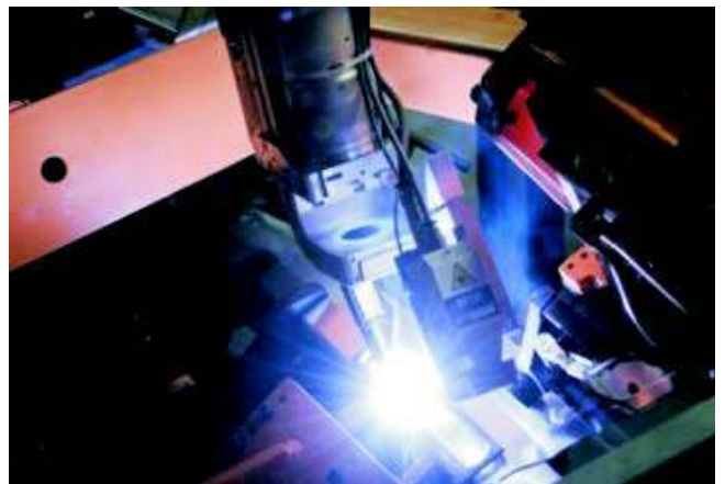
Bild 3: Einsatz des Laserstrahl-MIG-Hybridschweißverfahrens bei der Fertigung des Audi A8 Fig. 3: Application of the Laser Beam-MIG-Hybrid Welding Method in Manufacturing of the Audi A8
