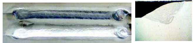
Bild 2: Draufsicht (links) und Querschliff (rechts) einer Laser-MIG-Hybridschweißnaht Fig. 2: Horizontal Projection (left) and Cross Section (right) of a Laser Beam-MIG-Hybrid Weld
