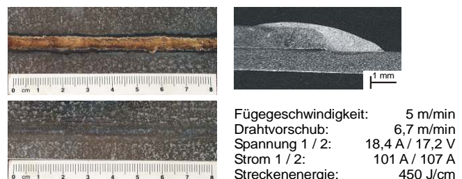
Bild 3: Querschliff und Nahtbilder einer Tandemlötung Fig 3: Cross section/brazing seam by GMA-Tandembrazing
