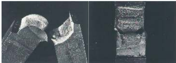
Bild 1: Versagen der Probe im Grundwerkstoff Fig. 1: Specimen failure in the bulk material
